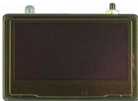
Индикационная панель, опционально устанавливаемая в составе **объектового** оборудования телеметрического комплекса **Spider - OM**.
