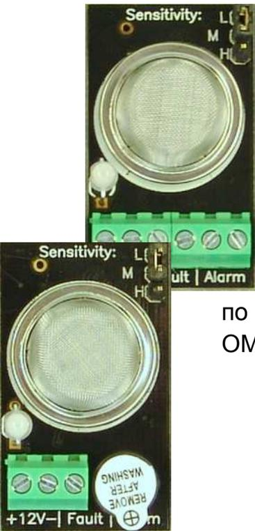
**CCGS-NB** с транзисторным выходом, способный работать по цифровой шине, в т.ч. в составе системы мониторинга "Spider-OM". Дополнительно оборудован звуковой сигнализатор
